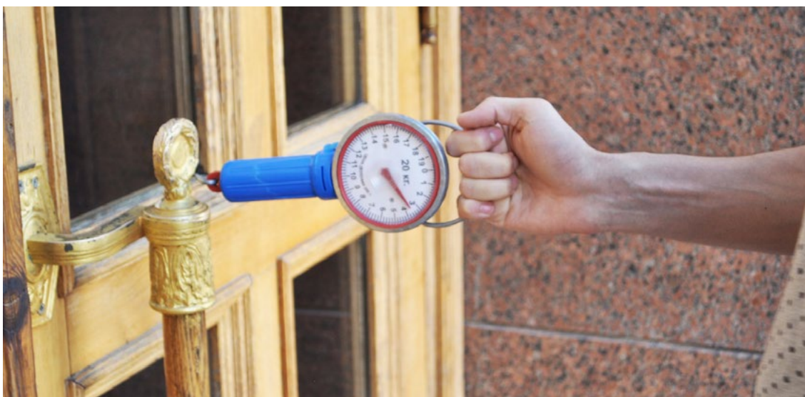
Для відкриття дверей потрібно докласти зусилля у 3,5 кг
